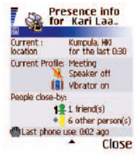
Abbildung 4.1: Das ContextContacts -Telefonbuch zeigt Informationen zur Situation, in der sich der andere Teilnehmer gerade befindet [ORT05].
