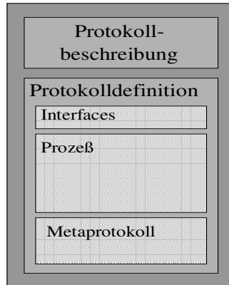
Abbildung 2: Struktureller Aufbau von OOPAMELA-Protokollen
